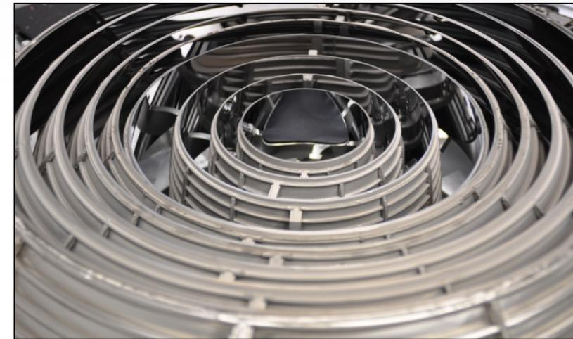
Collettore ad incidenza radente installato sulla macchina di esposizione litografica EUV di ultima generazione installata ad IMEC, in Belgio.
