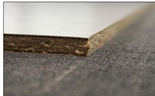
Progetto di sviluppo di materiali e packaging a mantenimento termico per il risparmio energetico nella logistica e nel trasporto di prodotti alimentari freschi. Immagini delle diverse fasi della preparazione dei campioni per le verifiche sperimentali: in ordine frantumazione, preparazione della polpa, formatura del pannello e pressatura.
